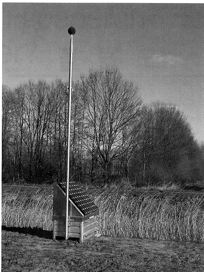
AFBEELDING 3: GELUIDMETER MET ZONNECELLEN
