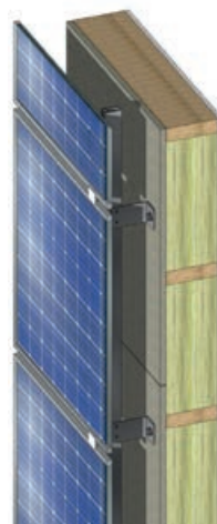
PV-panelen op een onbrandbare achterplaat.
