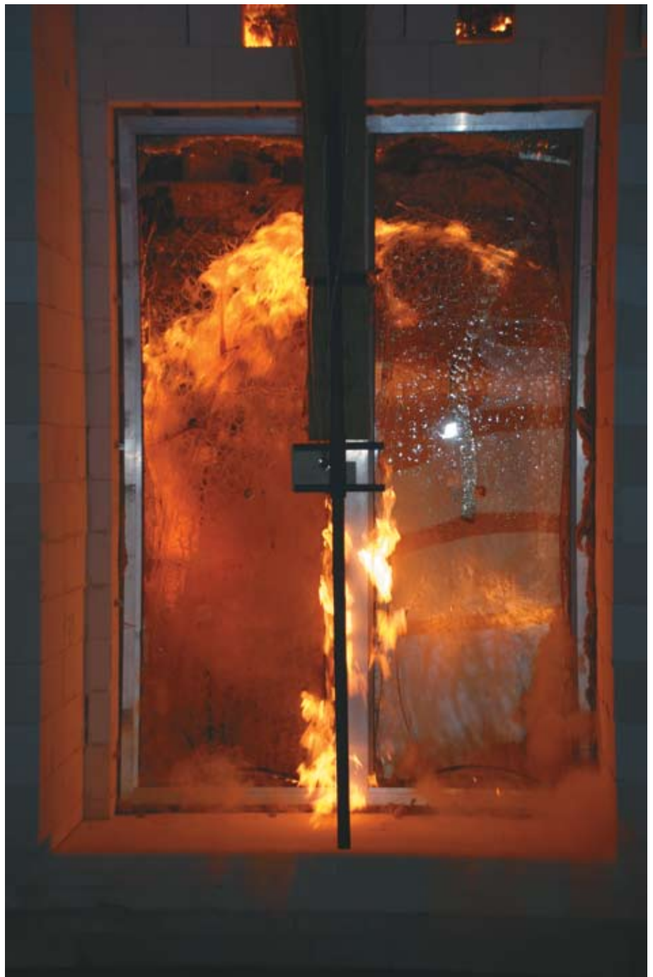
Beproeving van een aluminium gevelelement.
